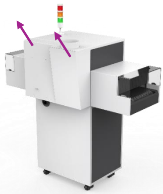
Abbildung 17. Lösen Sie die Schrauben über der linken und rechten Seite der oberen Abdeckplatte
