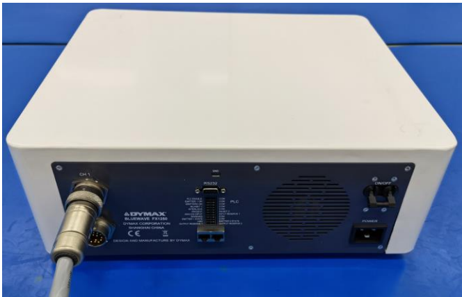
Abbildung 31. Das Verbindungskabel in die Steuereinheit einstecken
