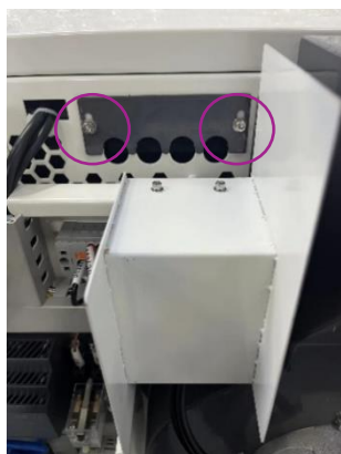
Abbildung 18. Heben Sie die Vorderseite der oberen Abdeckung an; Ziehen Sie den Stecker heraus; Entfernen Sie die obere Abdeckung
