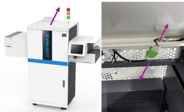
Abbildung 20. Befestigen Sie den Stecker am Anschluss des Emitters
