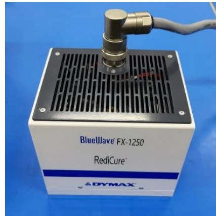
Abbildung 32. Das Verbindungskabel in den Strahler einstecken
