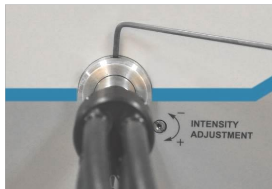
Abbildung 6: Spanschraube an Lichtleiteranschluss mit Inbusschlüssel leicht anziehen
