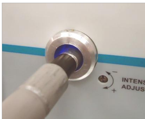
Abbildung 5: Lichtleiter in Lichtleiteranschluss einstecken
